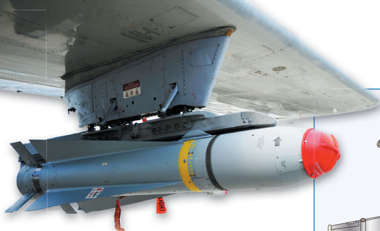
Под крылом данного Р-3 — ракета класса «воздух – поверхность» AGM-65 «Мэверик», предназначенная для поражения надводных бронированных целей
