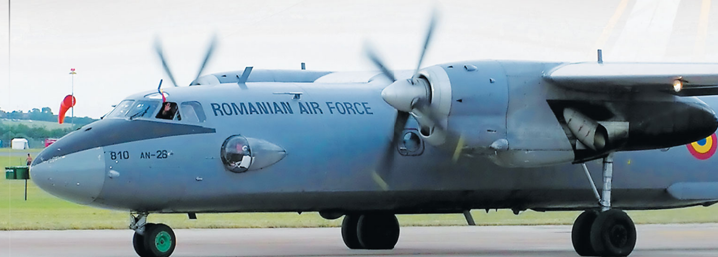
На левом борту военно-транспортных Ан-26 расположено большое выпуклое окно-блистер для визуального наведения и прицеливания при сбросе груза и десанта
