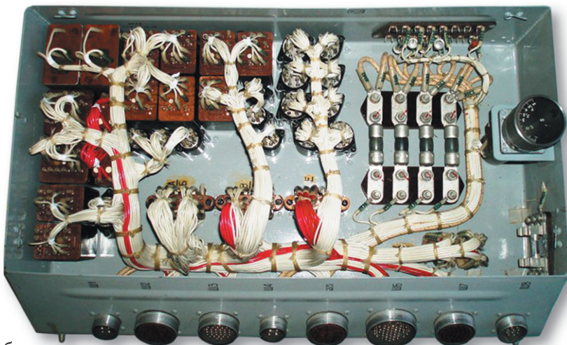
Части бортовой системы электроснабжения самолета: а — реле; б — распределительная коробка
