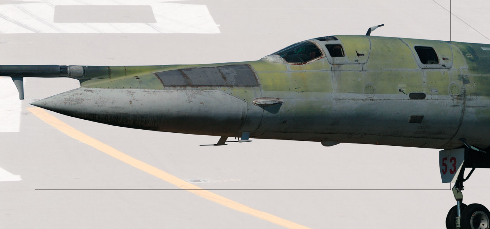
На «щеке» Ту-22М расположена антенна радиоэлектронной защиты, а на «загравке» — антенна бортового радиоэлектронного оборудования
