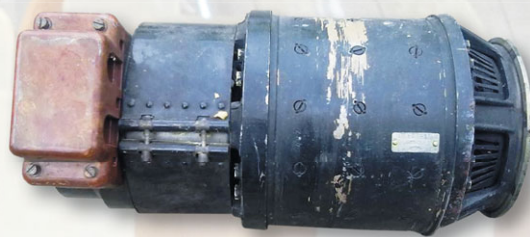
Часть бортовой системы электроснабжения самолета: генератор постоянного тока
