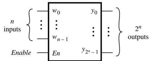
(d) An  $n$ -to- $2^n$  decoder**Figure 4.14** Binary decoder.
