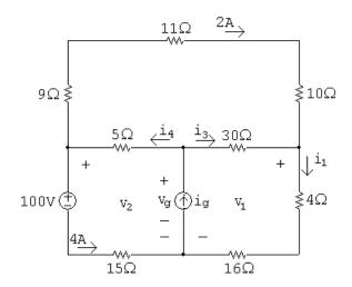
$$v_2 = 100 + 4(15) = 160 \,\mathrm{V}; \qquad v_1 = 160 - 30(2) = 100 \,\mathrm{V}$$
