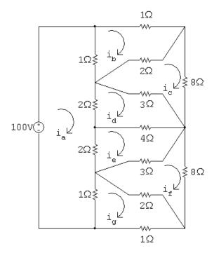
$$\begin{aligned} 100 &= 6i_a - 1i_b + 0i_c - 2i_d - 2i_e + 0i_f - 1i_g \\ 0 &= -1i_a + 4i_b - 2i_c + 0i_d + 0i_e + 0i_f + 0i_g \\ 0 &= 0i_a - 2i_b + 13i_c - 3i_d + 0i_e + 0i_f + 0i_g \\ 0 &= -2i_a + 0i_b - 3i_c + 9i_d - 4i_e + 0i_f + 0i_g \\ 0 &= -2i_a + 0i_b + 0i_c - 4i_d + 9i_e - 3i_f + 0i_g \\ 0 &= 0i_a + 0i_b + 0i_c + 0i_d - 3i_e + 13i_f - 2i_g \\ 0 &= -1i_a + 0i_b + 0i_c + 0i_d + 0i_e - 2i_f + 4i_g \end{aligned}$$
