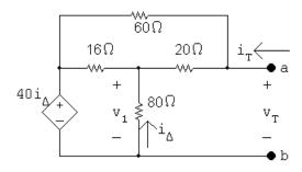
$$i_{\rm T} = \frac{v_{\rm T} - v_1}{20} + \frac{v_{\rm T} - 40i_{\Delta}}{60}$$
