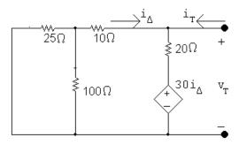
$$i_{\rm T} = \frac{v_{\rm T}}{30} + \frac{v_{\rm T} - 30(-v_{\rm T}/30)}{20}$$
