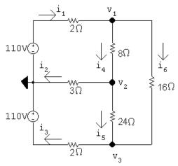
$$\frac{v_1 - 110}{2} + \frac{v_1 - v_2}{8} + \frac{v_1 - v_3}{16} = 0 \qquad \text{so} \qquad 11v_1 - 2v_2 - v_3 = 880$$
