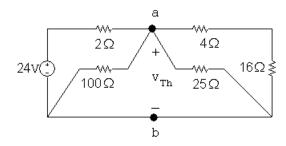
$$\frac{V_{\rm Th} - 24}{2} + \frac{V_{\rm Th}}{100} + \frac{V_{\rm Th}}{25} + \frac{V_{\rm Th}}{20} = 0$$
