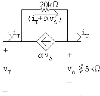
$$v_T = 20 \times 10^3(i_T + \alpha v_\Delta) + 5 \times 10^3 i_T$$
