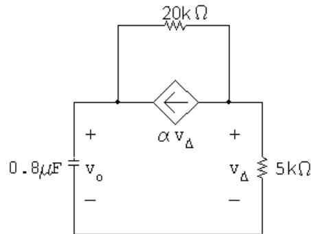
$$\frac{v_\Delta}{5000} + \frac{v_\Delta - v_o}{20,000} + 2.5 \times 10^{-4} v_\Delta = 0$$
