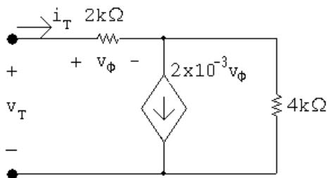
$$v_T = 2000i_T + 4000(i_T - 2 \times 10^{-3}v_\phi) = 6000i_T - 8v_\phi$$
