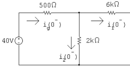
$$2\text{k}\Omega \parallel 6\text{k}\Omega = 1.5\text{k}\Omega$$
