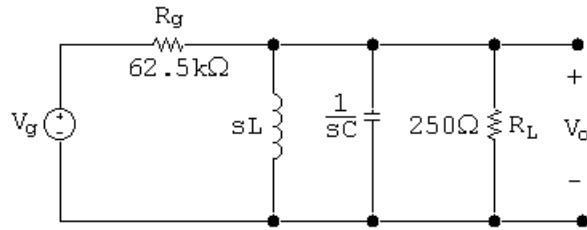
$$\frac{V_o}{250} + \frac{V_o}{sL} + V_o sC + \frac{V_o - V_g}{62.5 \times 10^3} = 0$$
