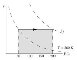
$Q_{\rm in} = C_{\rm p} \Delta T = C_{\rm p} (T_{\rm f} - T_{\rm i}) = \frac{5}{2} nR(T_{\rm f} - T_{\rm i})$
