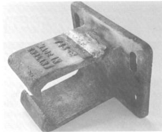
A braze weld in cast-iron.
