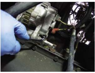
Step 3: Next, loosen the pivot bolt.
