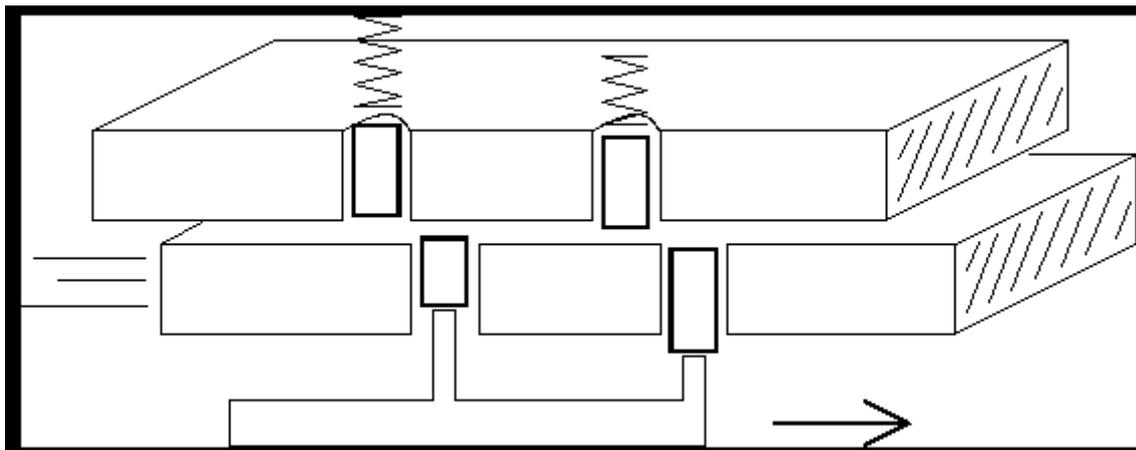
Schéma 3.3: (b) La clef adéquate permet aux plaques de glisser
